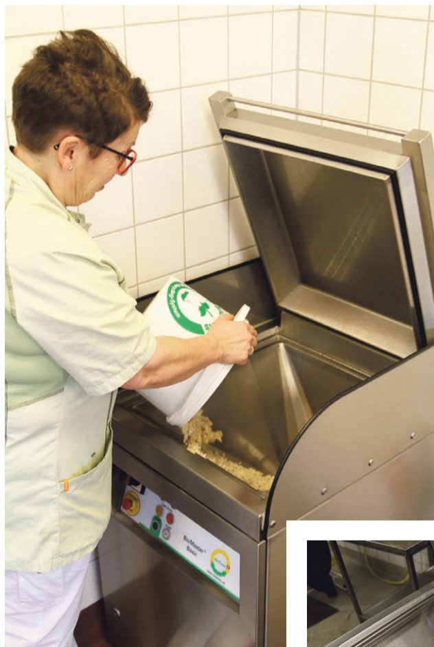
Kværnen, der ikke fylder meget mere end en vaskemaskine, i brug.
