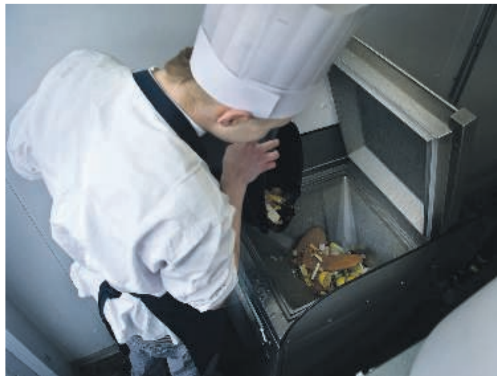
Alt madaffald fra spisestederne i Kolding Storcenter samles nu et sted og blendes i denne affaldskværn. Derved spares der blandt andet penge på kørsel med skraldebil, og affaldet genanvendes.
